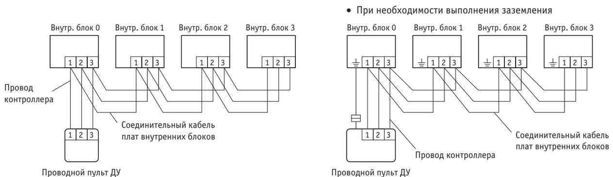
(2) Задайте адрес каждого блока (последовательно, начиная с "0") относительно пульта ДУ с помощью поворотного переключателя внутреннего блока. Смотри инструкции по установке внутренних блоков.
