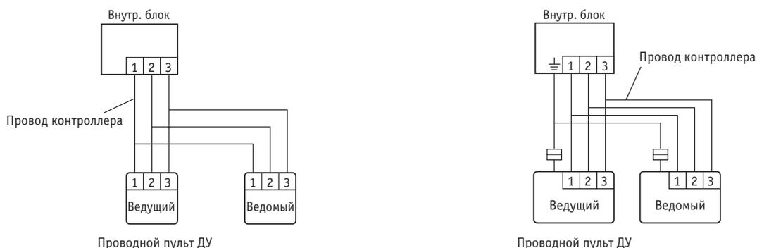
(2) В случае управления внутренним блоком посредством двух проводных пультов установите DIP-переключатели SW 1 и SW 2 основного и дополнительного пультов в соответствующее положение - ON или OFF.
