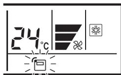
Изменение режима управления - по встроенному или выносному датчику - выполняется с помощью клавиши THERMO SENSOR.
