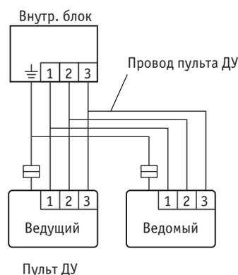
(2) В случае управления внутренним блоком посредством двух пультов установите DIP-переключатели SW 1 и SW 2 основного и дополнительного пультов в соответствующее положение - ON или OFF.
