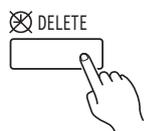
Для отмены установленных параметров расписания необходимо нажать кнопку DELETE, для изменения режима таймера - кнопку CLOCK ADJUST.
