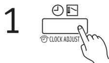
Нажмите на кнопку установки времени CLOCK ADJUST и удерживайте ее нажатой приблизительно 2 секунды. На дисплее начинает в мигающем режиме отображаться время.
