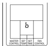
(4) Подтверждение заданного кода сигнала с одновременным выходом из режима осуществляется повторным нажатием клавиши MASTER CONTROL.
