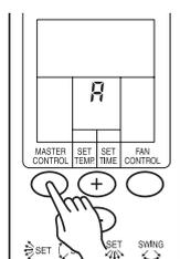
(3) При последовательном нажатии клавиши (+) или (-) код сигнала изменяется в следующей последовательности:
