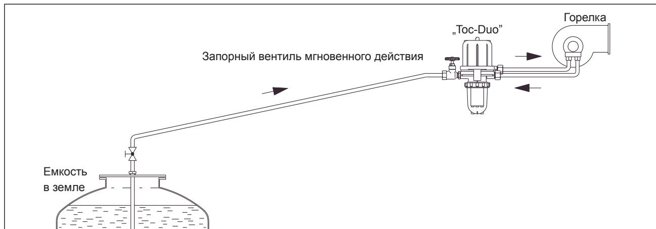
Трубопроводы присоединяются с помощью запорных вентилей (см. рисунки).
