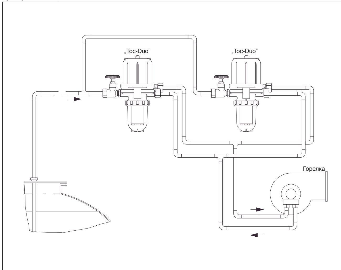
Параллельное подключение двух „Toc-Duo”
