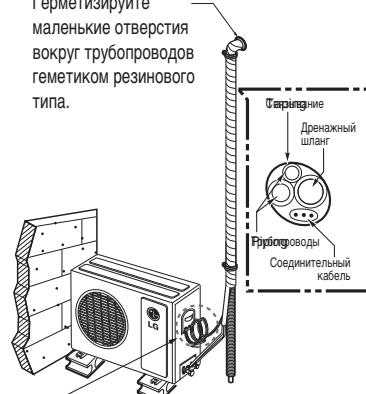
Для исключения попадания воды в электрические схемы необходим гидравлический затвор
