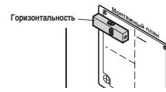
4. Высверлите перфорированный участок до диаметра 50 мм под соединительный трубопровод (в случае перфорирования задней поверхности).
