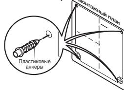
7. Повесьте изделие, пользуясь его отверстиями, на верхние винты и снимите монтажный план.
