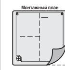
3. Сделайте отверстие диаметром 6 мм и глубиной 30–35 мм в отмеченных точках.
