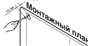
8. Верните нижние части после того, как закроете отверстия изделия пластиковыми анкерами, и полностью затяните верхние винты.
