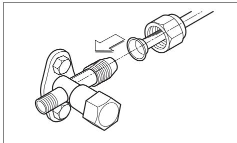
Окончательно затяните конусную гайку ключом с тарированным усилием до тех пор, пока ключ не щелкнет.
