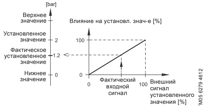
Рис. 24 Пример настройки регулирования установленного значения
