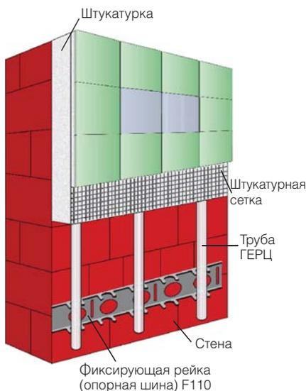
**Расход материала на 1 м<sup>2</sup> стенового панельного отопления с интервалом укладки (VA) 50 мм:**
