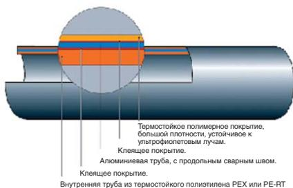
Для внутренней трубы используется специальный PE-RT полиэтилен, с повышенной термостойкостью по стандартам DIN 16 833. При этом речь идет об этиленоктановом сополимере; на основе молекулярной структуры с основной этиленовой цепью и боковой октановой, получается высокая плотность, а также хорошая гибкость и длительная прочность.
