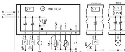
Схема соединений, тип 230 V, 1 7794 23
