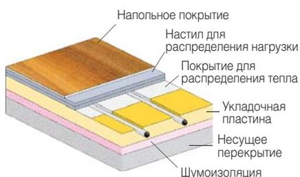
Для напольного отопления «сухим» способом укладки необходимо соблюдение следующих требований:
