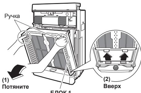
**4** Снимите противостоящие пластины электродов с задней стороны БЛОКА 1.
