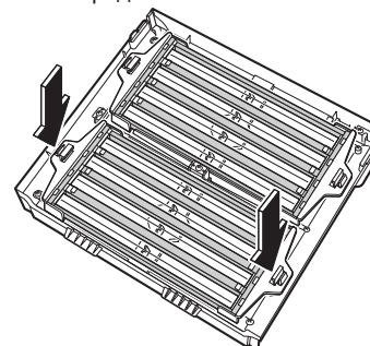
**2** Установите на место БЛОК 1 ►Стр. 31., предварительный фильтр, емкость с водой и переднюю панель. ►Стр. 29.
