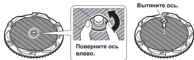
**4** Снимите увлажняющий фильтр с водяного колеса и прикрепите новый фильтр.
