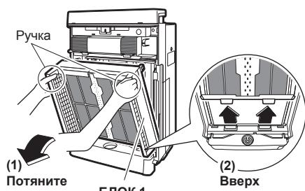
**4** Извлеките блок дезодорирующего катализатора.
