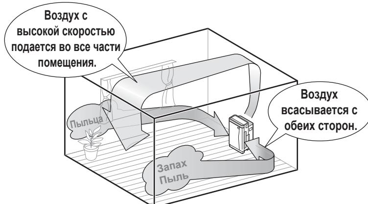
**Мощное всасывание при использовании высокой скорости воздушного потока позволяет захватывать пыль, пыльцу и т.п. Стримерный разряд расщепляет формальдегид и запахи.**
