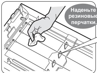
Очистите ионизированную проволоку, не извлекая ее из V-образной канавки.
