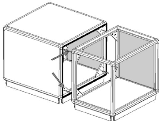
В случае, если возможен доступ изнутри через дверцу или панель, монтаж блоков необходимо осуществить с помощью угловых накладок (крепежные детали не входят в комплект поставки).
