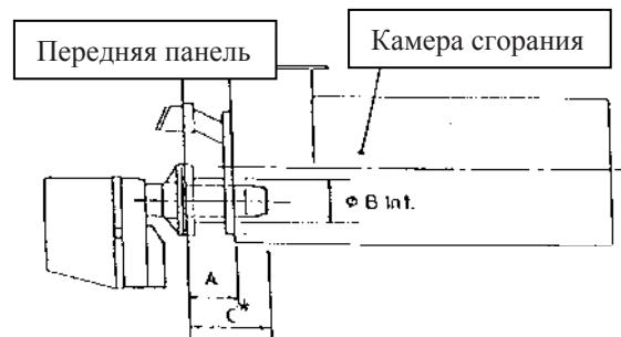
C\* Установка фланца на горловине горелки.
