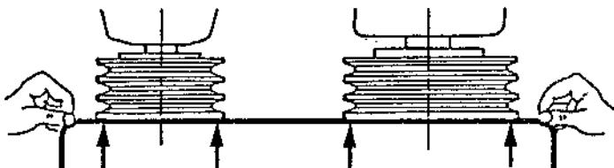
Проверить и отрегулировать натяжение ремней. При нажатии пальцем на каждый ремень, они должны опускаться на 25 мм по отношению к их нормальной позиции. Промыть ремни тетрахлорметаном (или другой подходящей жидкостью), в случае, если они скользят после осуществления их правильного натяжения, Заменить комплект ремней, если пришел в негодность один из ремней.
