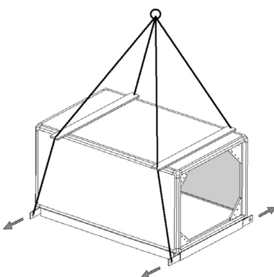
Никогда не перемещайте блоки, закрепив стропы на монтажных соединениях, фланцах, трубках, ручках доступа, шарнирах, отверстиях забора воздуха.
