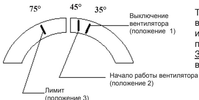
Термостат вентилятора установлен внутри воздухонагревателя. Он настроен и отрегулирован на заводе производителе.
