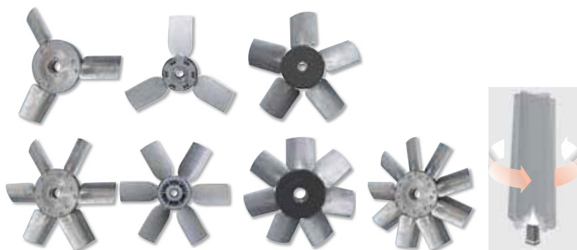
Крыльчатки с 3, 5, 6, 7 или 9 лопатками и регулируемый угол их наклона позволяют подобрать вентилятор максимально близко к заданной рабочей точке.
