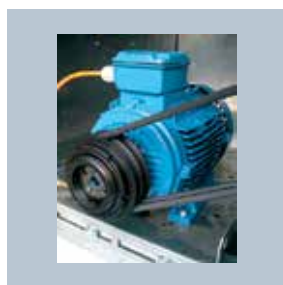
Система натяжения ременной передачи
