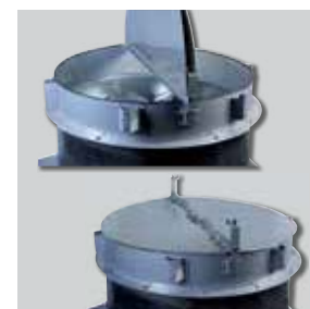
Обратный клапан При выключенном вентиляторе препятствует обратному потоку воздуха и защищает от дождя.
