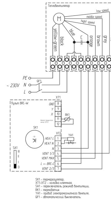
**Групповое подключение водяных тепловентиляторов к пульту BRC-W.**
