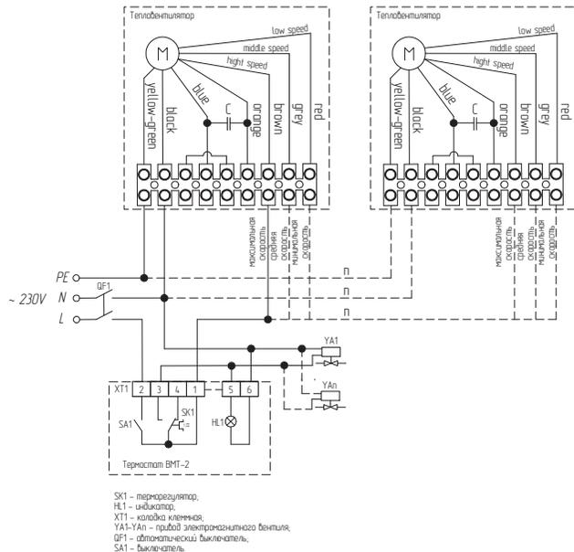
**Подключение водяного тепловентилятора к пульту BRC-W.**
