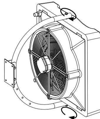
Примерное размещение теплоventилаторов при настенном монтаже
