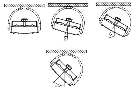
Кронштейн даёт возможность поворота теплоventилатора вокруг оси крепления на 140 градусов.
