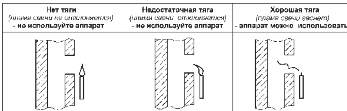
Рисунок 7. Способ проверки тяги в дымоходе
