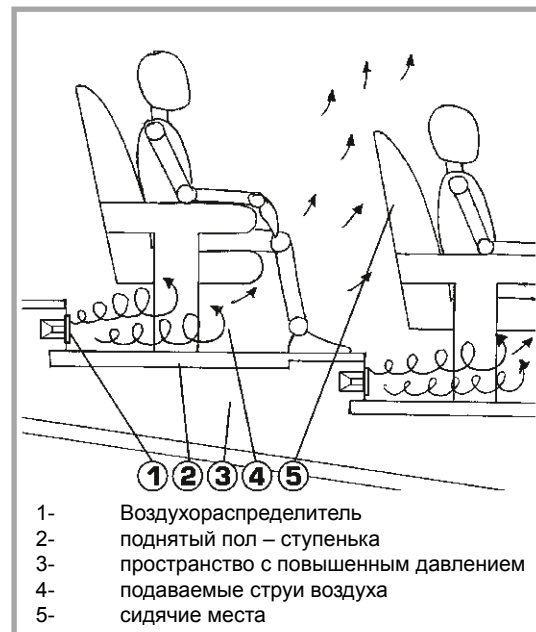
Схема работы воздухораспределителей NWO-DN60
