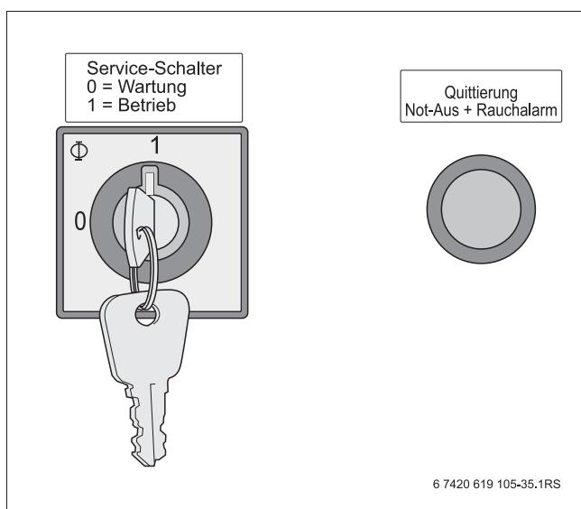
Рис. 6 Сервисный выключатель в положении 1
