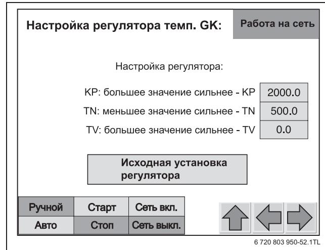
Рис. 41 Ручной уровень "Настройка регулятора температуры охладителя смеси"
