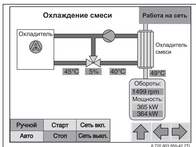
Рис. 17 Охлаждение смеси
