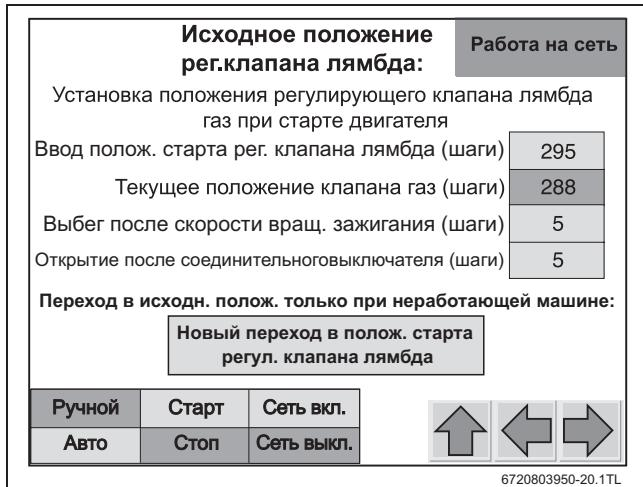
Рис. 34 Экран настройки "Исходное положение регулирующего лямбда-клапана"
