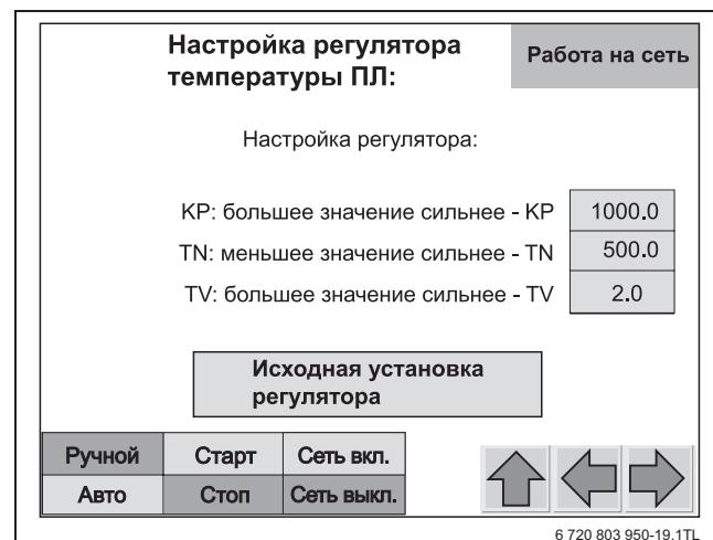
Рис. 33 Экран "Настройка регулятора температуры подающей линии"
