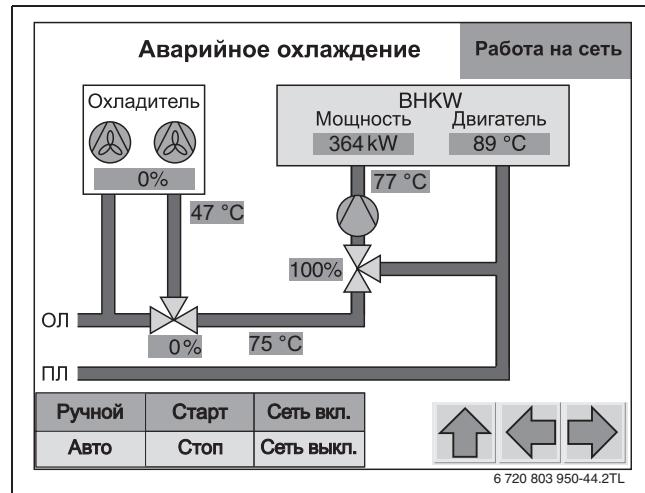
Рис. 19 Аварийное охлаждение
