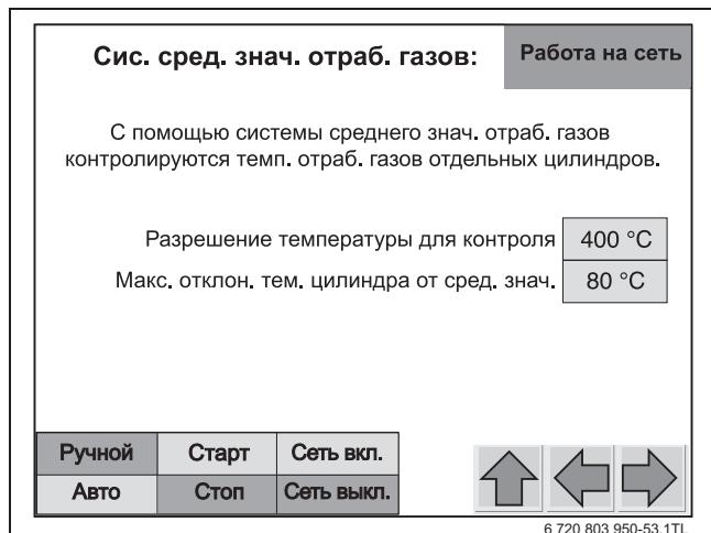
Рис. 42 Ручной уровень "Среднее значение температуры отработанных газов"
