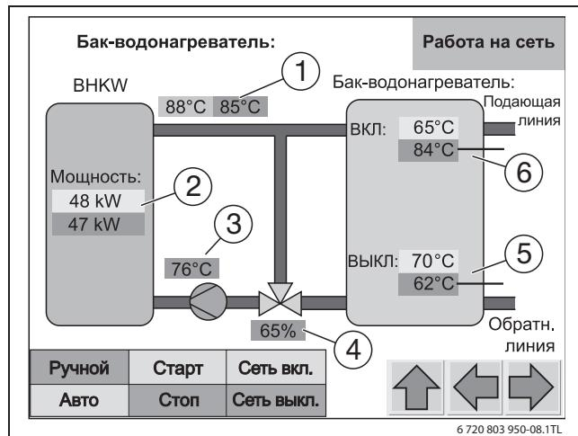
Рис. 12 Рабочий экран "Бак" с 3-ходовым клапаном
