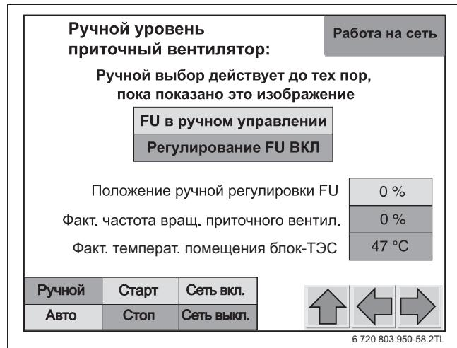
Рис. 50 Ручной уровень "Вентилятор воздуха для горения"
