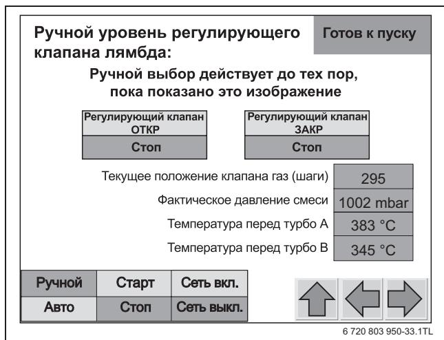
Рис. 48 Ручной уровень "Регулирующий лямбда-клапан"
