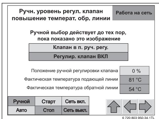
Рис. 49 Ручной уровень "Регулирующий клапан повышения температуры обратной линии"
