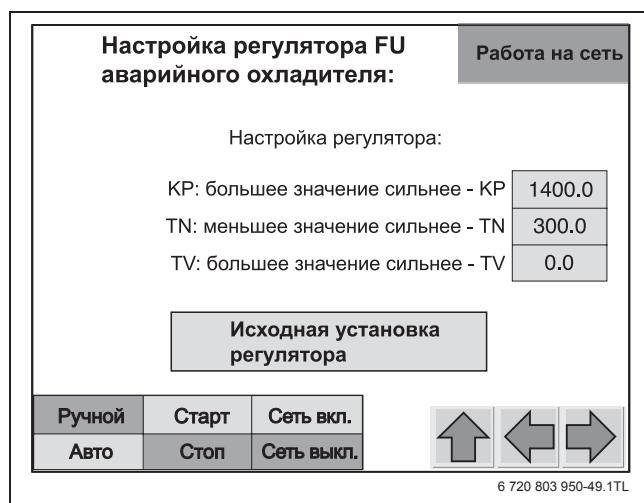
Рис. 38 Ручной уровень "Настройка регулятора FU аварийного охладителя"
