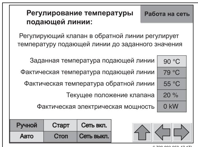
Рис. 31 Экран настройки "Регулирование температуры подающей линии"
