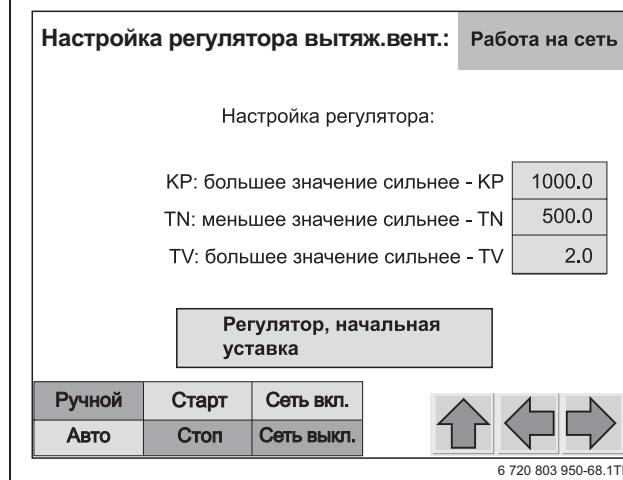
Рис. 30 Экран "Настройка регулятора вытяжного вентилятора"
