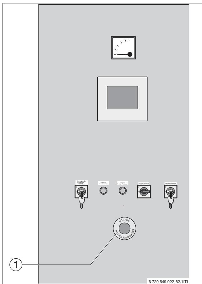
Рис. 57 Кнопка аварийного выключения
