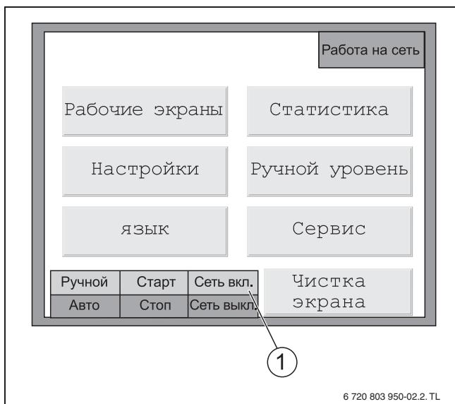
Рис. 8 Включение силового реле генератора
