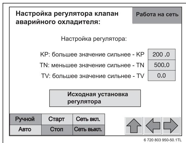
Рис. 39 Ручной уровень "Настройка регулятора клапана аварийного охладителя"
