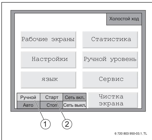
Рис. 7 Включение установки
