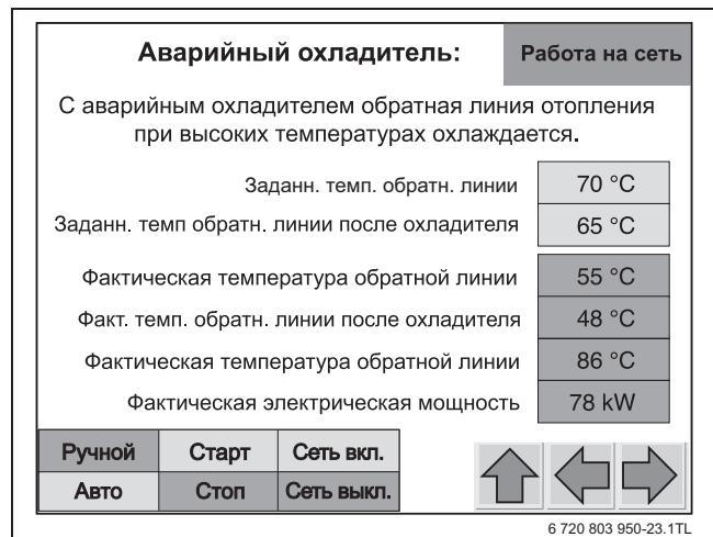
Рис. 37 Экран настройки "Аварийный охладитель"
