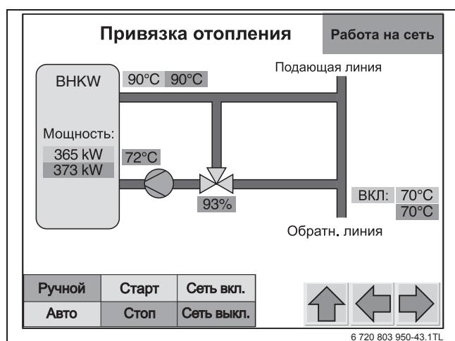
Рис. 18 Привязка отопления
