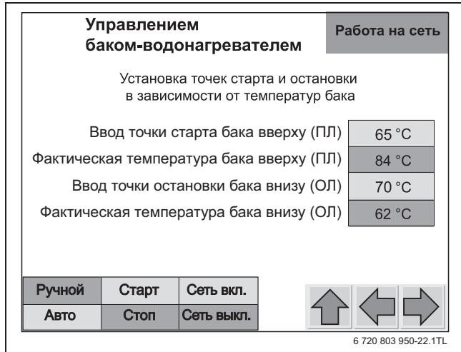
Рис. 36 Экран настройки "Управление бойлером"
