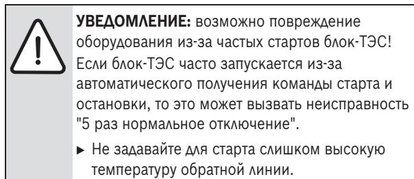
Команда старта может подаваться по температуре обратной линии отопительной системы. Для этого нужно непосредственно перед точкой подключения к блок-ТЭС установить дополнительный датчик температуры в обратную линию отопительной системы.
