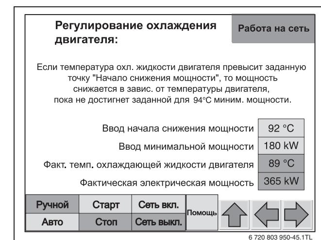
Рис. 27 Экран настройки "Регулирование системы охлаждения двигателя"
