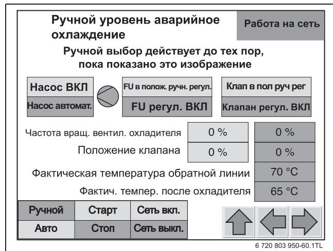
Рис. 51 Ручной уровень "Аварийное охлаждение"
