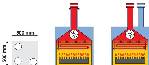
**C42** Конструкция котла разработана для использования с коллективными системами дымоходов, имеющими 2 трубы: одну для прямого забора воздуха, вторую для отвода продуктов сгорания посредством коаксиальных или раздельных систем дымоходов.
