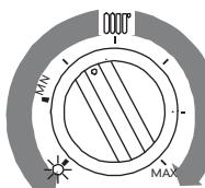
Повернуть регулятор температуры ОТОПЛЕНИЯ
