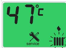
При поаороте регулятора (B) в минимальное положение, котел будет работать на минимальной мощности. (символы будут гореть постоянно, будет мигать).
