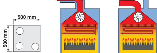
**C32** конструкция котла разработана для использования с вертикальными системами дымоходов и прямым забором воздуха (коаксиальные или раздвоенные системы дымоходов). Расстояние между трубами забора воздуха и отвода отходящих газов должно быть не менее 250 мм, но в любом случае обе трубы должны располагаться в квадрате со стороной 500 мм.
