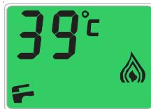
Если на дисплее отображается символ () , указанная температура относится к контуру ГВС.
