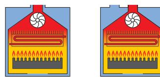
**C82** Котел, предназначенный для подключения к коллективной системе забора воздуха и индивидуальным или коллективным дымоходом для отвода продуктов сгорания.
