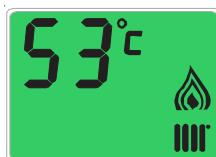
Если на дисплее отображается символ () , указанная температура относится к контуру отопления.
