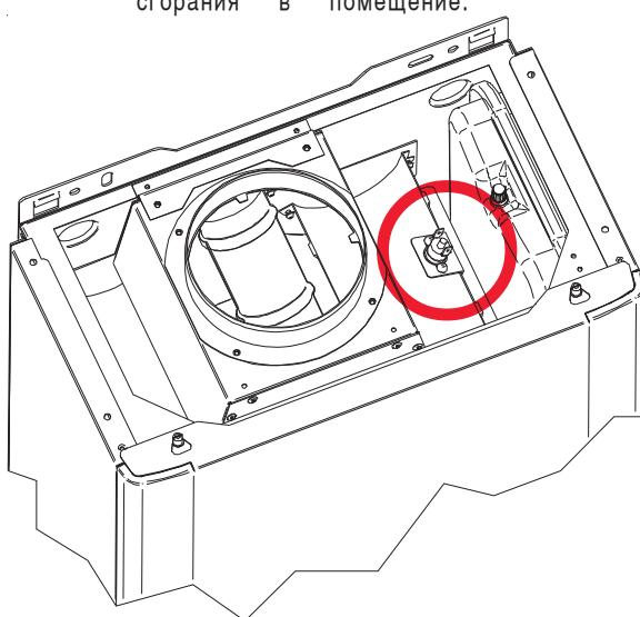
В случае срабатывания устройства котел блокируется и на дисплее отображается неисправность (символ ).
