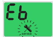
1) При наличии неисправности, которая не приводит к остановке котла, для отображения кода ошибки необходимо нажать на кнопку разблокировки; в случае если котел находится в режиме ожидания, код ошибки будет постоянно отображаться на дисплее.
