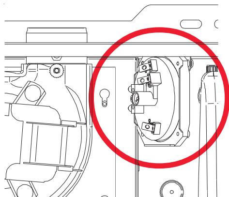
В случае срабатывания устройства котел блокируется и на дисплее отображается неисправность (символ )
