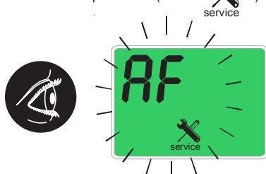
После остывания датчика можно разблокировать котел нажатием на кнопку разблокировки.
