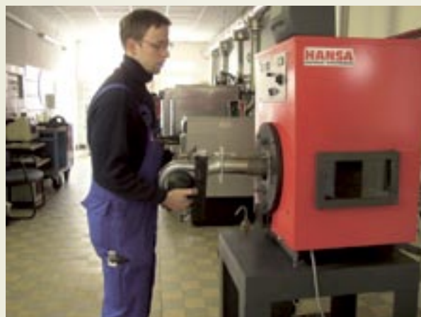
Рис.3 Горелка вставляется в топочную камеру
