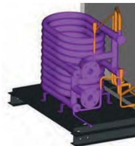
Водяной теплообменник типа "труба в трубе"
