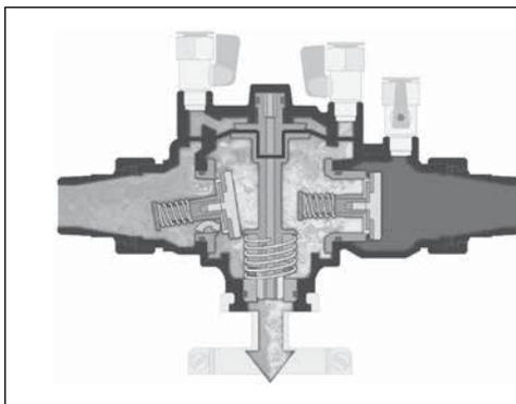
4. В случае нарушения герметичности обратного клапана со стороны сети водоснабжения:
