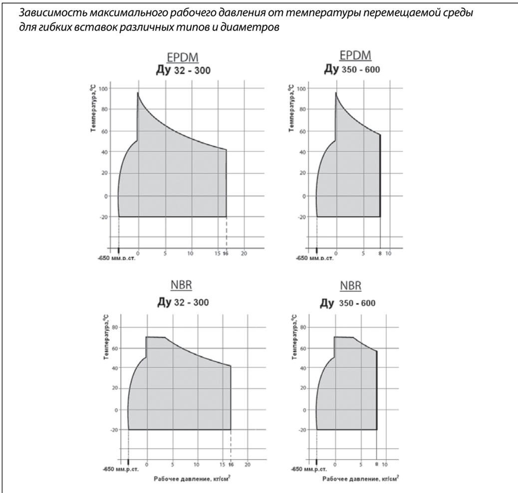
При эксплуатации гибких вставок в условиях отрицательных температур окружающей среды следует применять теплоизолирующие кожухи.
