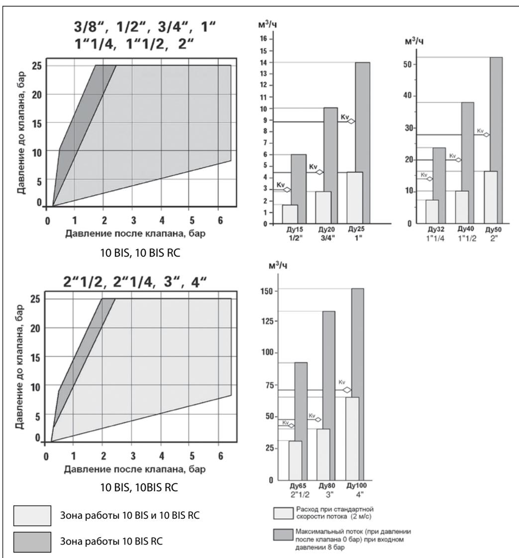
На правых диаграммах указаны расходы через редукционный клапан при стандартной скорости воды 2 м/с, а также максимальный расход (на прямой излив в атмосферу) через клапан с заводской настройкой 3 бара.
