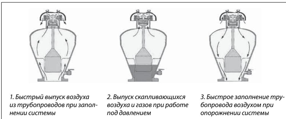
Схема установки клапана VE330 на трубопровод
