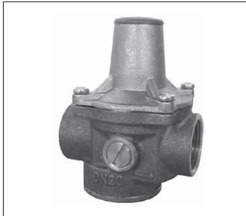
Клапаны редукционные типа 7BIS являются регуляторами давления прямого действия "после себя" и предназначены для снижения и поддержания постоянного давления за клапаном вне зависимости от колебаний давления до него.
