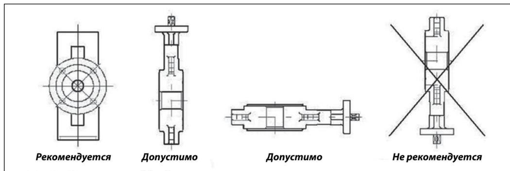
В целях увеличения срока эксплуатации затвора рекомендуется руководствоваться указанными ниже расстояниями. Затвор, установленный вблизи соединения труб, попадает в зону турбулентности, что увеличивает его износ.
