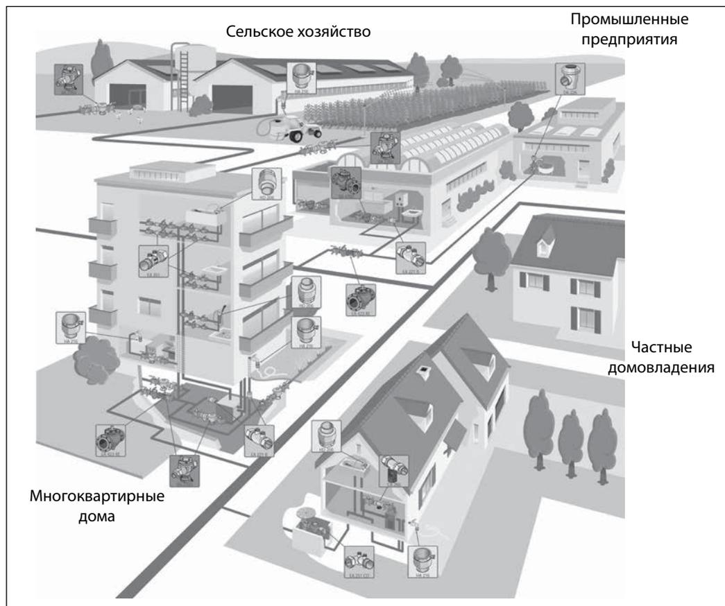
Обратные клапаны ттипа BAVM, BAVMCD и BA4760 применяются в качестве устройств, через которые производится подключение потребителей воды к сетям питьевого водоснабжения.
