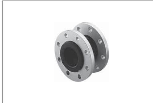
Гибкие вставки предназначены для предотвращения передачи механических вибраций по трубопроводным системам, например, от насосного оборудования. Они могут также использоваться в качестве компенсаторов тепловых удлинений трубопроводов в пределах деформаций, указанных в приведенных ниже технических описаниях, для гальванической развязки трубопровода
