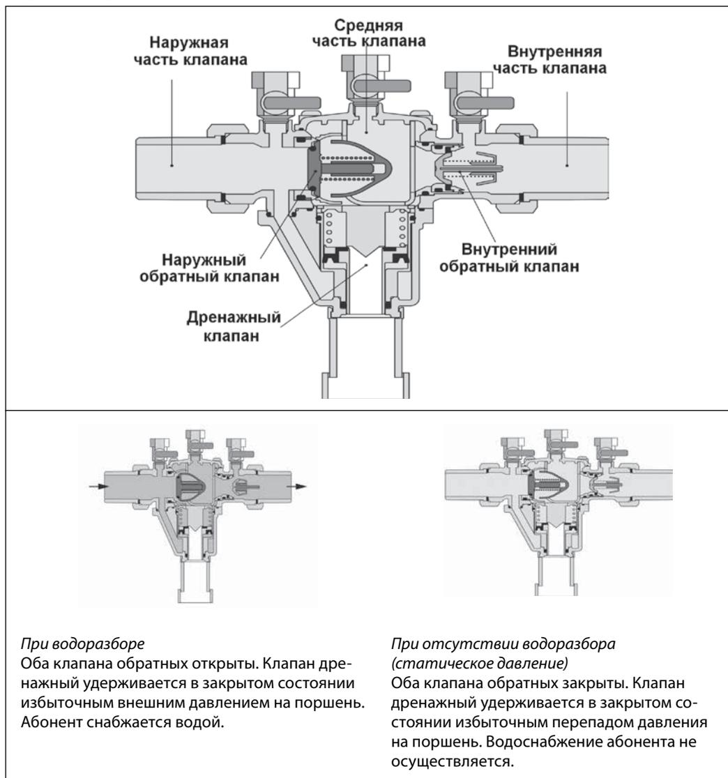
**В случае некорректной работы системы (перебой внешнего давления, избыточное давление во внутренней сети абонента, заклинивание клапана)**
