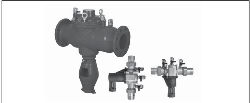
Защита сетей осуществляется путем автоматического прерывания водоснабжения абонента, с последующим опорожнением клапана и удалением поступившей от абонента воды с возможными загрязнениями в дренаж. Все клапаны поставляются проверенными на работоспособность в заводских условиях. Конструкция обратных клапанов ВАВМ, ВАВМCD, ВА4760 позволяет проводить периодическую проверку на работоспособность без демонтажа и прекращения подачи воды абоненту.
