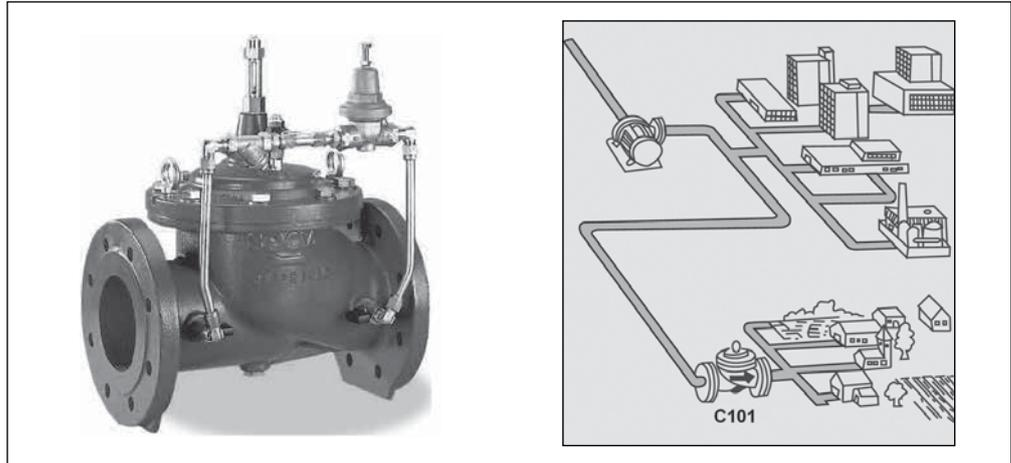
Регулирующий клапан С101 уменьшает и поддерживает постоянное пониженное давление «после себя» независимо от изменения давления до регулятора и водоразбора после него.
