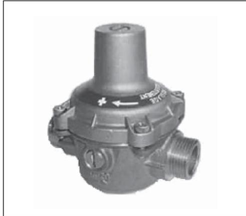
Клапаны редукционные типа 11BIS являются регуляторами давления прямого действия "после себя" и предназначены для снижения и поддержания постоянного давления за клапаном вне зависимости от колебаний давления до него.
