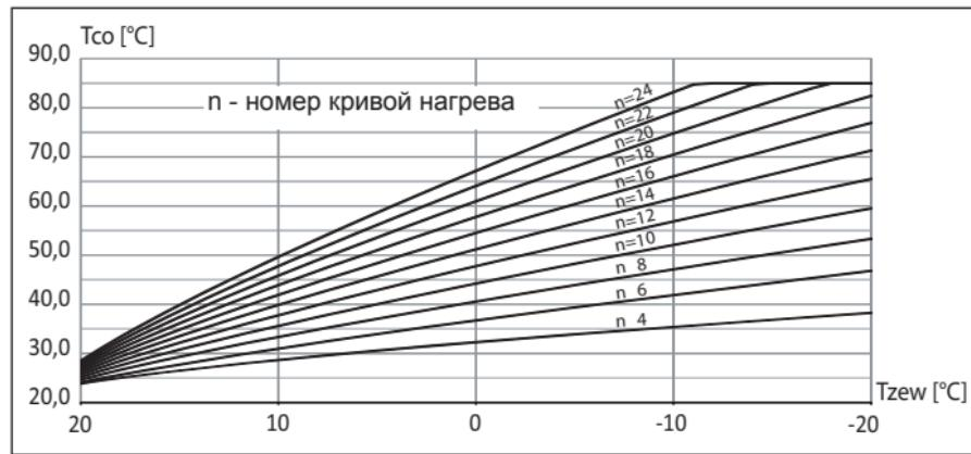
В случае необходимости переноса кривой необходимо изменить параметр (перенос кривой). На рисунке, для примера, представлена кривая №12 с переносом  $-10^{\circ}\text{C}$  и  $10^{\circ}\text{C}$ .
