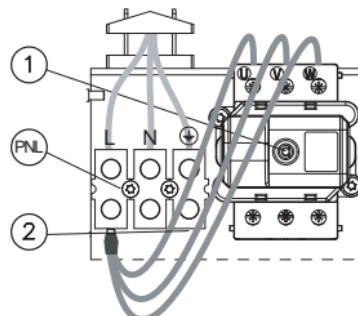
**Подключение к однофазной электросети (касается котлов мощностью 4кВт, 6кВт и 8кВт).**
