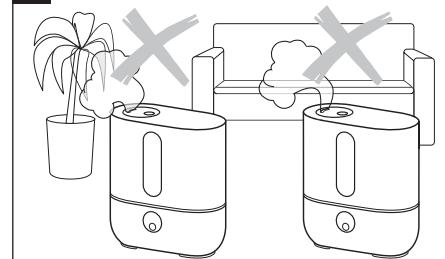
Nehmen Sie das Gerät bei leerem Wassertank nicht in Betrieb! Bei Unterschreiten des minimalen Wasserstandes, schaltet das Gerät automatisch aus.
