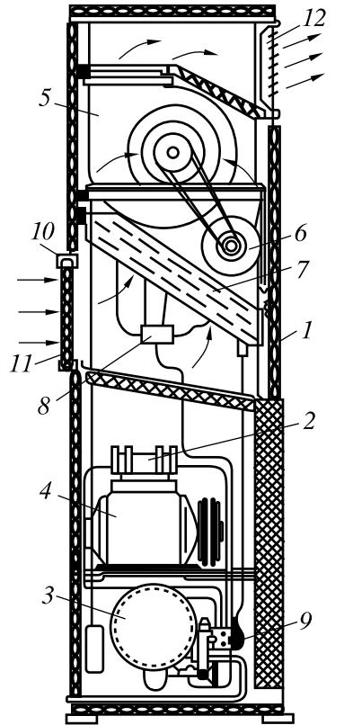
1 - корпус с теплозвуковой изоляцией; 2 - компрессор; 3 - конденсатор; 4 - электродвигатель компрессора; 5 - центробежный вентилятор; 6 - электродвигатель вентилятора; 7 - спираль-ноленточный калорифер; 8 - разводка хладагента; 9 - четырехходовой кран; 10 - воздухозаборная решетка; 11 - ячейка масляного воздушного фильтра; 12 - приточная решетка
