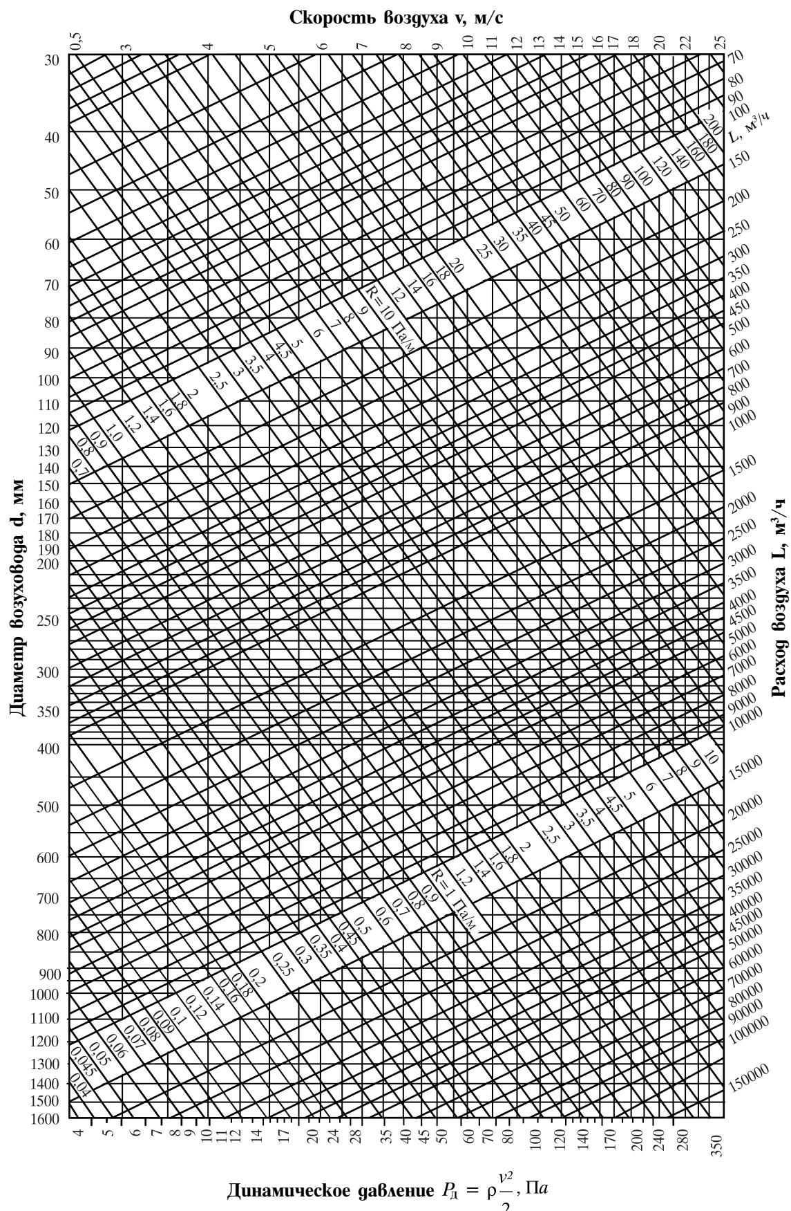
Рис. 9.22. Номограмма для диаметра круглых воздуховодов системы механической вентиляции и потерь давления на трение в них
