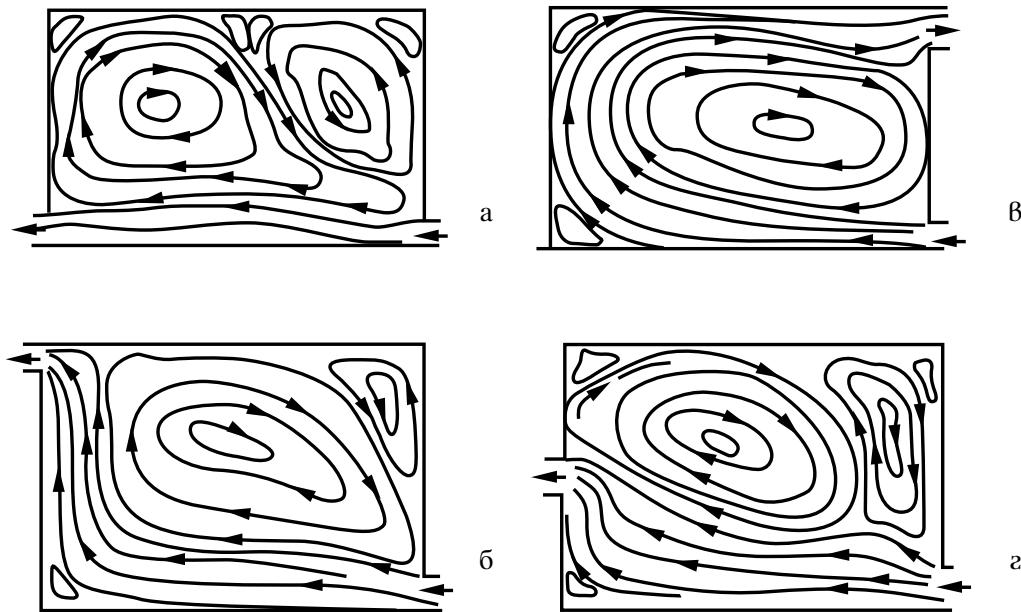
Рис. 10.11. Схемы движения воздушных потоков в вентилируемом помещении
