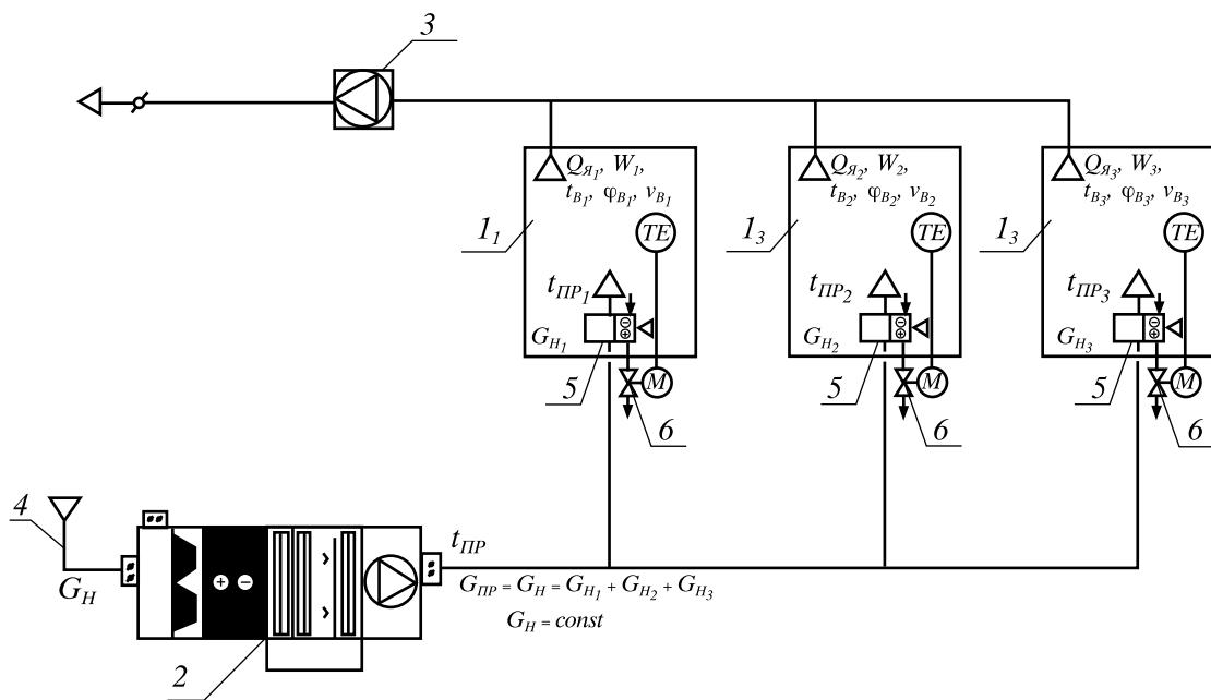
Рис. 9.17. Принципиальная схема системы кондиционирования воздуха с эжекционными кондиционерами-довоодчиками:
