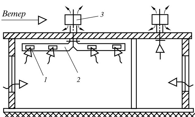
Рис. 9.6. Естественная вентиляция здания под действием ветра:
