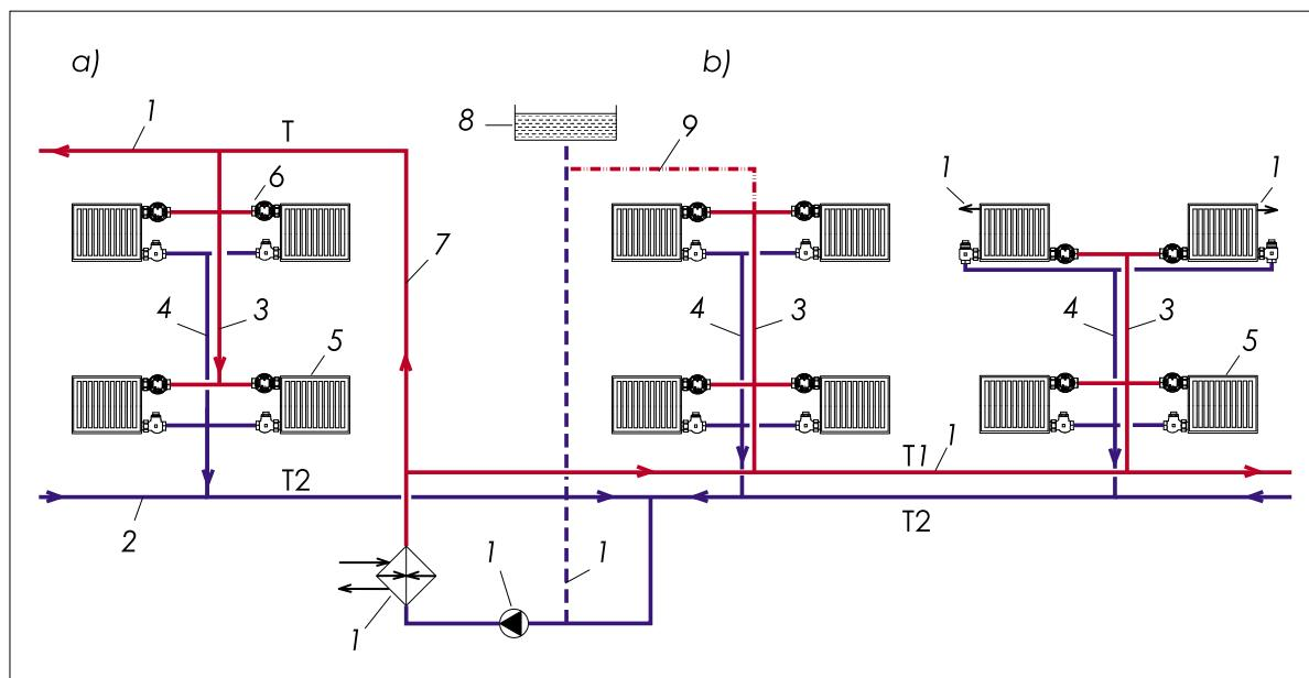
Рис. 8.1. Схемы Вертикальной двухтрубной системы водяного отопления:
