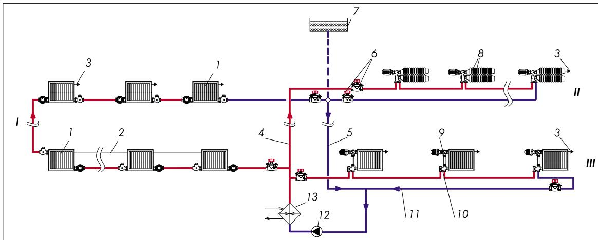
Рис. 8.7. Схемы горизонтальной однотрубной системы водяного отопления:
