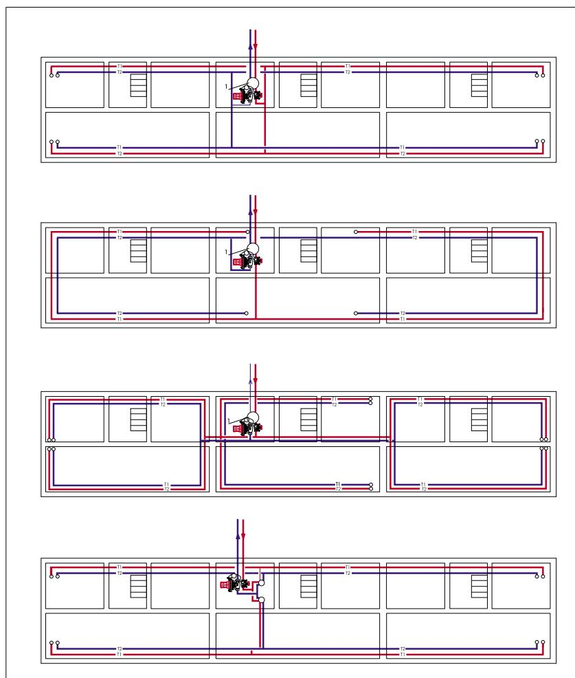
Рис. 8.8. Магистрали систем водяного отопления с нижней разводкой:
