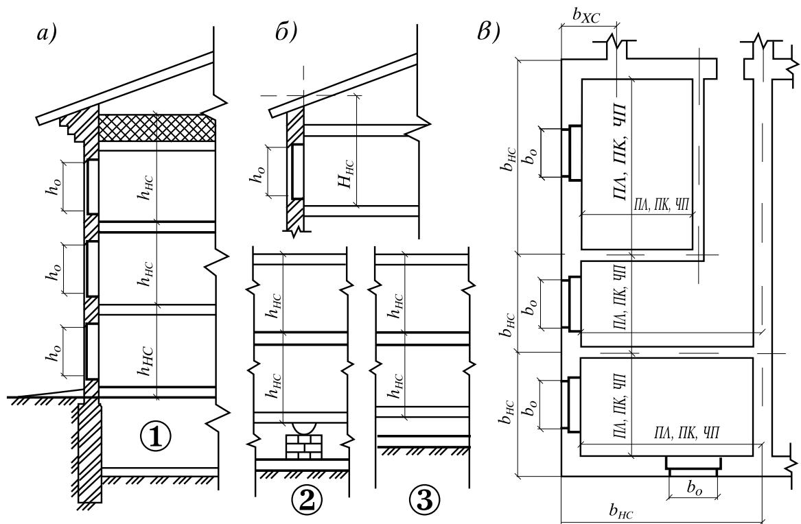
Рис. 8.9. Правила обмера площадей ограждающих конструкций:
