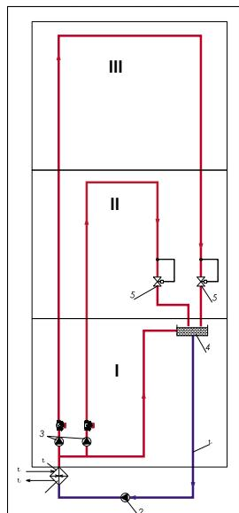
Рис. 8.5. Схема водяного отопления высотного здания: I и II - зоны здания с водоводяным отоплением; III - зона здания с пароводяным отоплением;
