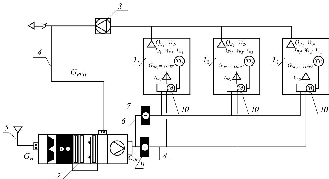
Рис. 9.15. Принципиальная схема двухканальной системы кондиционирования воздуха:
