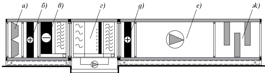
Рис. 10.3. Приточная установка системы кондиционирования CVA (VTS KLIMA) производительностью 400 - 46200 м<sup>3</sup>/ч
