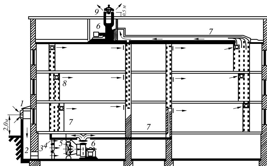
Рис. 9.8. Приточно-вытяжная вентиляция общественного здания:
