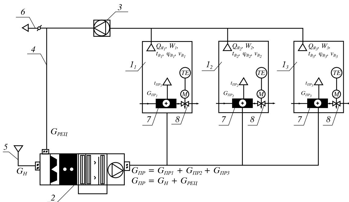
Рис. 9.14. Принципиальная схема центральной системы кондиционирования воздуха
