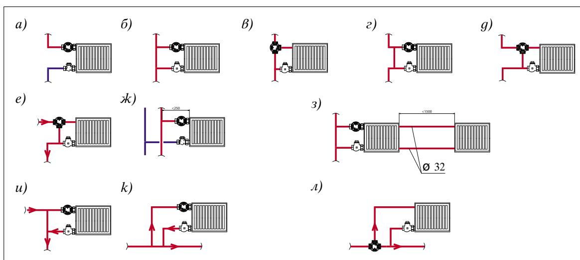
Рис. 8.15. Схемы одностороннего присоединения труб к отопительным приборам:
