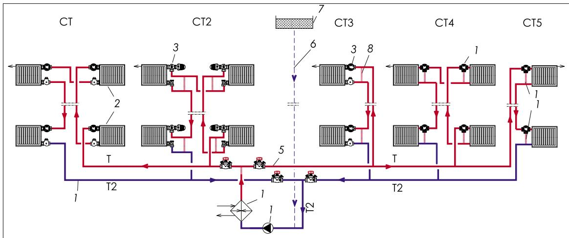
Рис. 8.4. Схема Вертикальной однотрубной системы водяного отопления с нижней разводкой обеих магистралей и П-образными стояками:
