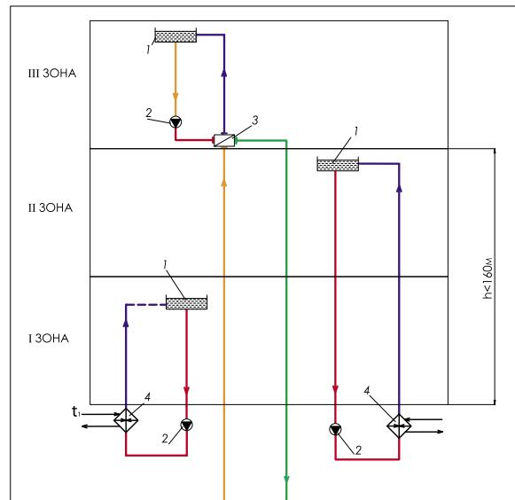
Рис. 8.6. Схема единой системы водо-водяного отопления высотного здания:
