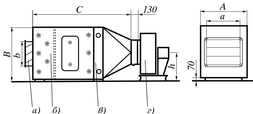
Рис. 10.2. Приточная установка «Тепло-ЛОТ» (ПУ)
