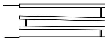
Рис. 8.12. Отопительные приборы: а) змеевик; б) регистр
