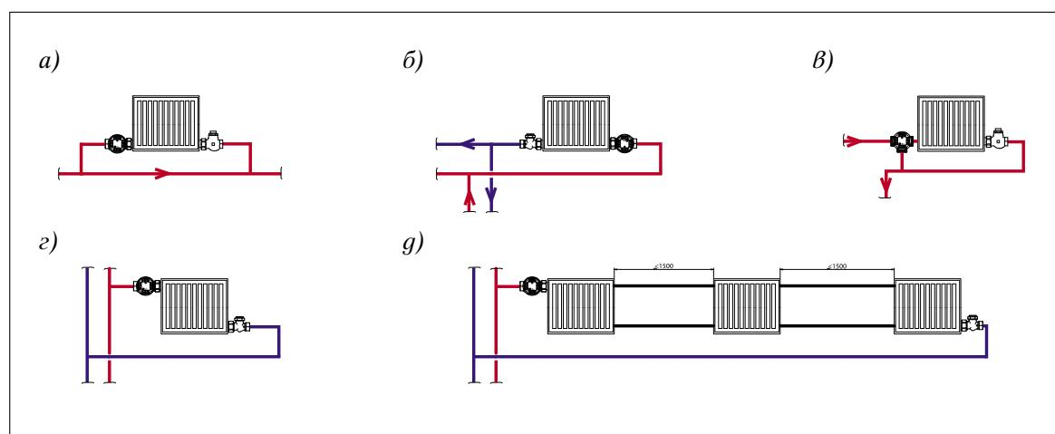
Рис. 8.16. Схемы разностороннего присоединения труб к отопительным приборам:
