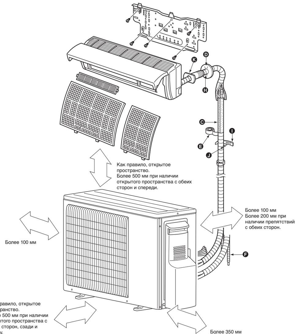
**Примечание:** Расстояния рядом со стрелками на рисунке выше требуются для обеспечения эффективной работы кондиционера. Устанавливайте кондиционер, по возможности, на открытом пространстве в целях облегчения в будущем работ по техобслуживанию и ремонту.
