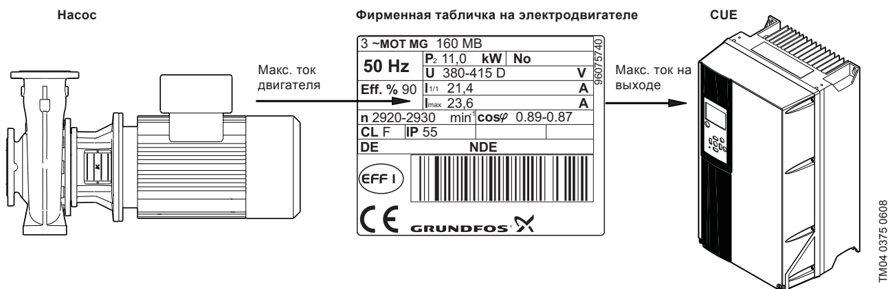
Рис. 48 Подбор CUE на основании максимального тока двигателя.
