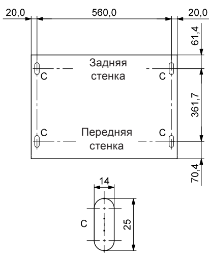
Рис. 59 Шаблон для сверления под подставку (мм)
