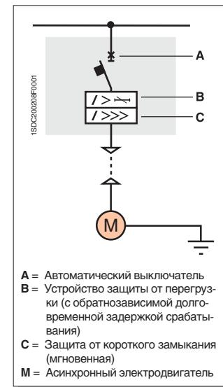
Схема прямого пуска асинхронного электродвигателя при помощи только автоматического выключателя, оснащенного электронным расцепителем.
