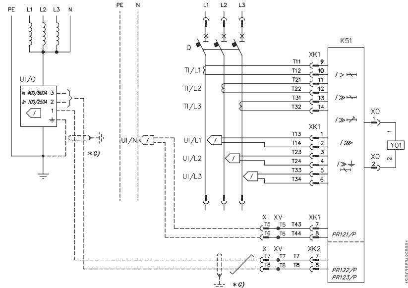
Трехполюсный автоматический выключатель с микропроцессорным расцепителем PR121/P, PR122/P или PR123/P
