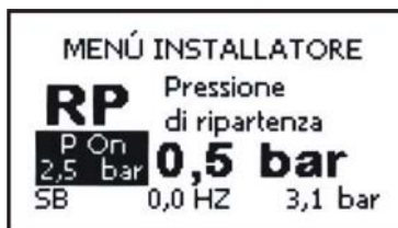
Рисунок 13: Настройка давления нового включения
