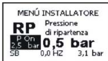
Figura 13: Impostazione della pressione di ripartenza
