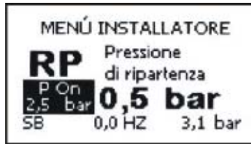
Afbeelding 13: instelling van de druk voor herstart
