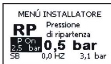
Figure 13: Configuration de la pression de redémarrage
