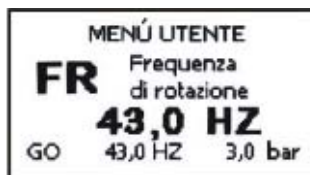
Figura 12: Visualizzazione di un parametro di menù
