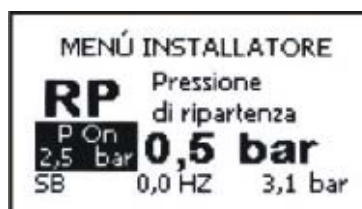
Figura 13: Configuración de la presión por re arranque
