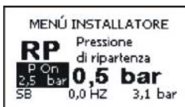
Abbildung 13: Einstellung des Neustartdrucks
