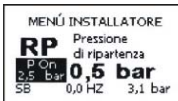
Σχήμα 13: Ρύθμιση της πίεσης επανεκκίνησης
