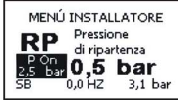
Şekil 13: Yeniden başlatma basıncının ayarlanması
