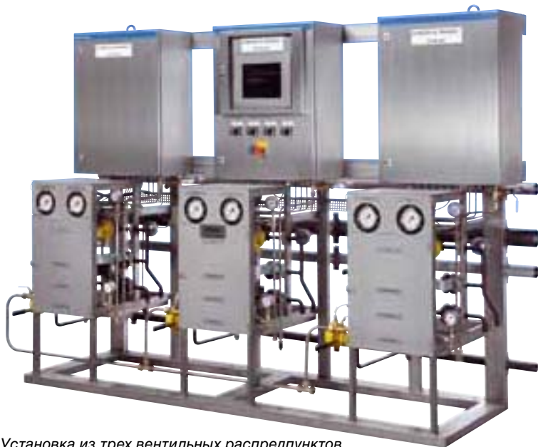
Установка из трех вентильных распределителей
