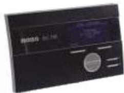
ORION 700 – блок управления всеми приемниками и термостатами, в маркировке которых присутствует число 700. Управление происходит по радиосигналу. Блок питается от сети 220 В. В самом блоке прописываются программы работы термостатов на час, день, неделю. Для термостатов конвекторов Nobo могут быть заданы четыре режима работы: комфортный, экономичный, незамерзания (+8), все выключено. При временных перебоях электропитания все настройки сохраняются.
