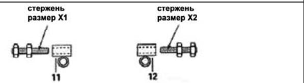
Во соединительные элементы с резьбой (11, 12) вставьте стержни (13) с размерами **X1** и **X2** и наверните на стержни гайки.
