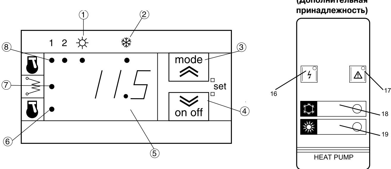
Контроллер с помощью дисплея и светодиодов, расположенных на панели управления и индикации, отображает состояние агрегата, значения параметров и аварийные коды.
