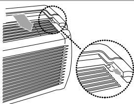
Чтобы получать наилучшие результаты при эксплуатации вашего кондиционера, вы должны регулярно чистить его для удаления пыли, скапливающейся на воздушном фильтре.
