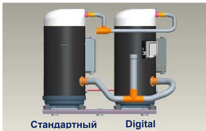
Рис 22: Тандем из компрессоров ZRD125K* и ZPD103K* - ZPD182K*
