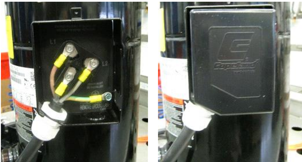
Рис 29: Правильное подключение клеммной коробки IP21 с использованием кабельной муфты
