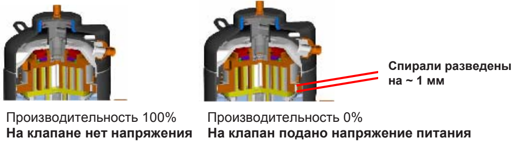
Рис 4: Регулирование производительности компрессоров ZRD42K* - ZRD81K* и ZPD34K* и ZPD91K*
