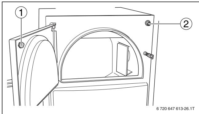
Рис 15 Контактный выключатель двери
