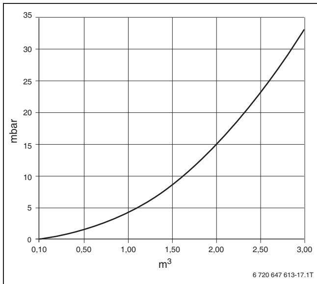
Рис 5 Гидравлическое сопротивление в зависимости от объемного расхода
