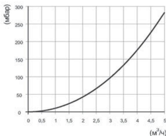
Рис.2 Сопротивление потока [мбар] подачи котла GA 110 E в виде функции от количества воды [ $m^3/h$ ].
