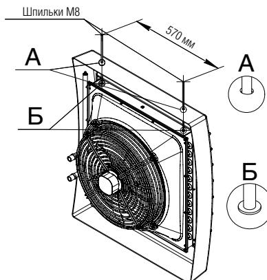
**Горизонтальное подключение:** резьбовые монтажные отверстия (4 шт.) предусмотрены на задней панели аппарата. Для монтажа обогревателя посредством монтажных шпилек необходимо ввести шпильки M8 через отверстия предусмотренные в корпусе (вид А) и закрепить их посредством шайбы, гайки и гровера (вид Б).
