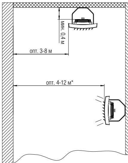
\*при горизонтальной установке направляющих
