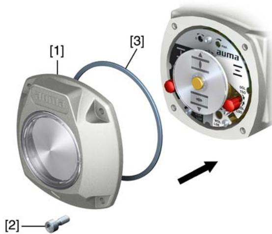
4. Снять крышку [1] отсека выключателей.
