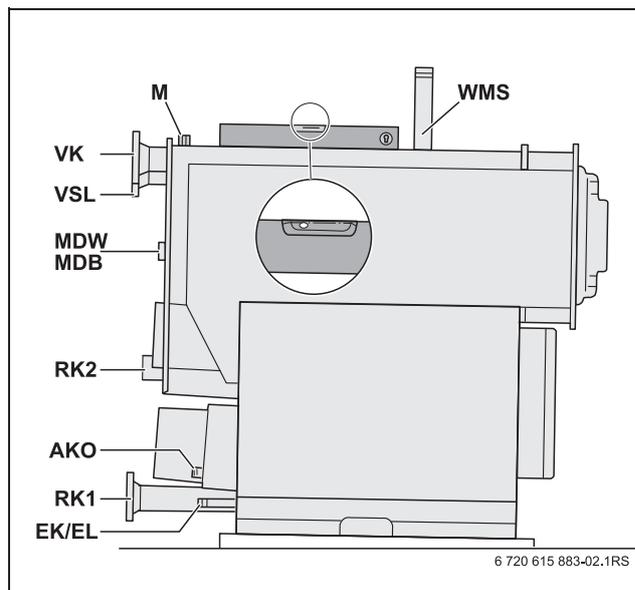
Рис. 3 Выравнивание котла с уклоном назад (пояснения см. рис. 1, стр. 6)
