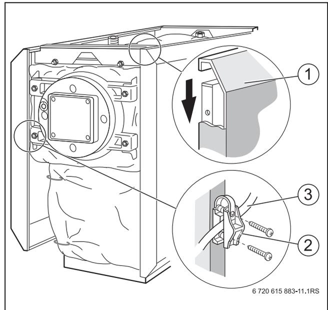
Рис. 13 Установка боковых стенок и прокладка кабеля горелки
