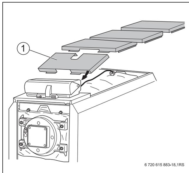
Рис. 22 Укладка крышек котла - схематичное изображение
