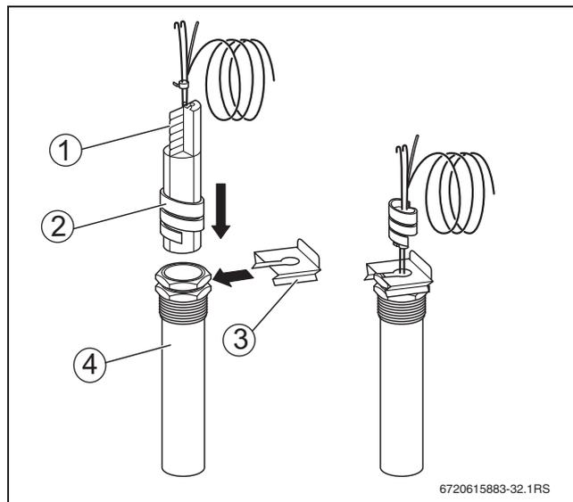
Рис. 21 Установка пластмассовой спирали в погружную гильзу.
