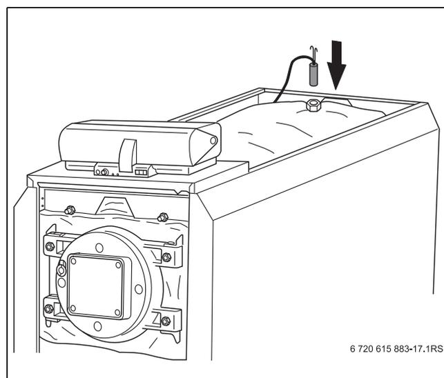
Рис. 20 Установка датчиков температуры в погружную гильзу
