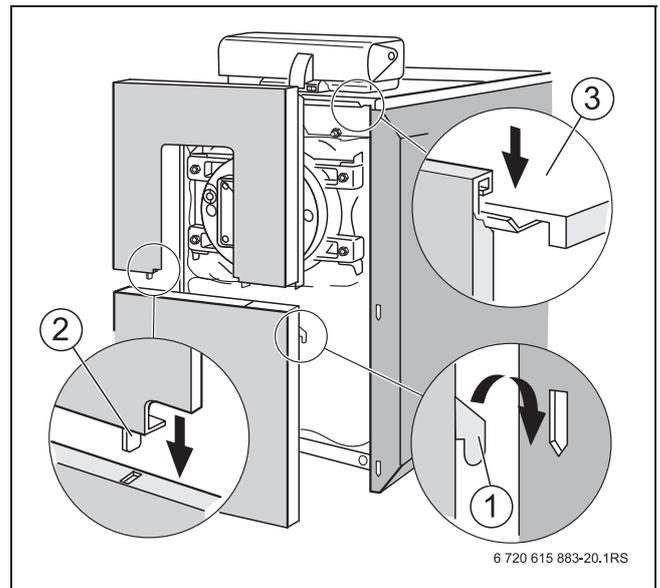
Рис. 24 Крепление верхней и нижней передних стенок
