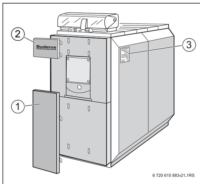
Рис. 25 Крепление заводской таблички
