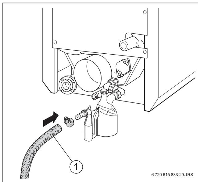
Рис. 26 Монтаж устройства нейтрализации
