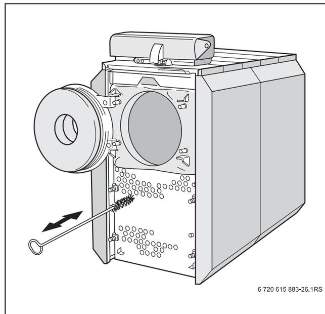
Рис. 31 Чистка щёткой труб дополнительных поверхностей нагрева
