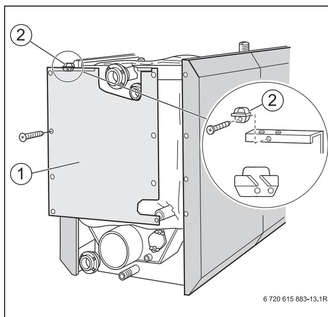
Рис. 15 Крепление задней стенки (котлы от 400 до 640 кВт)
