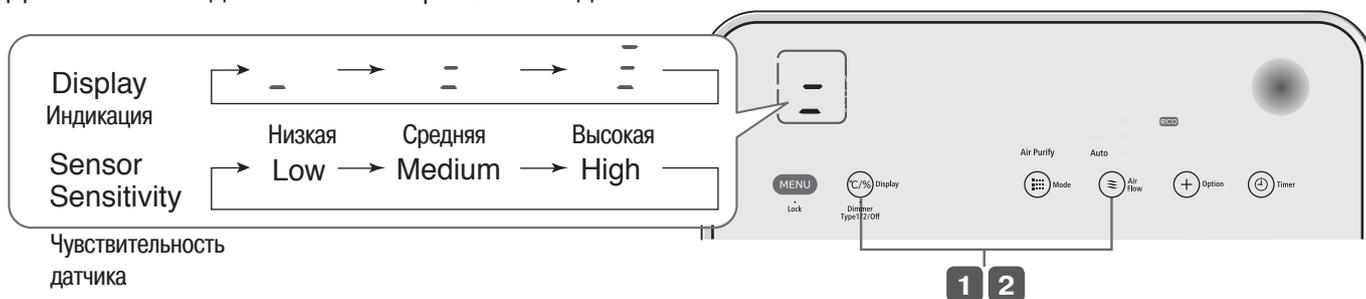
**1** Нажимая кнопку Display, нажмите и удерживайте кнопку в течение 3 сек. Текущая чувствительность датчиков отобразится на дисплее. (Установка по умолчанию: ).
