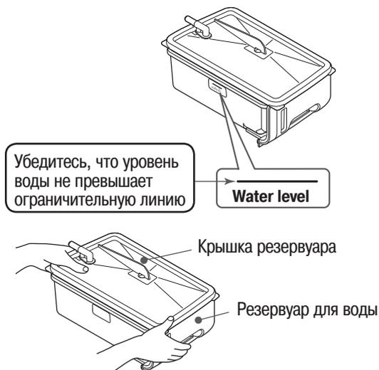
**Установите резервуар для воды в устройство.**
