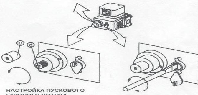
НАСТРОЙКА ПУСКОВОГО ГАЗОВОГО ПОТОКА
