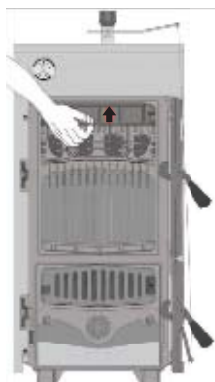
б) демонтируйте пластину колосников
