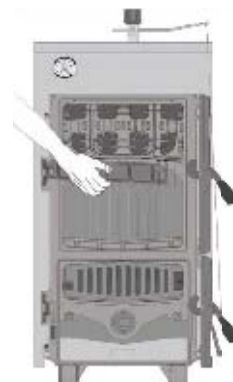
б) демонтируйте пластину колосников
