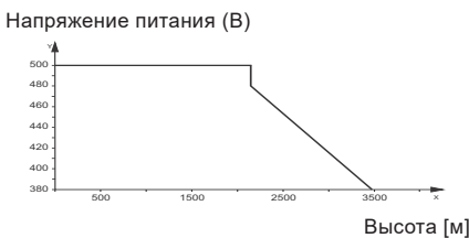
Рис. 14 Напряжение питания для трёхфазного электродвигателя в зависимости от высоты над уровнем моря
