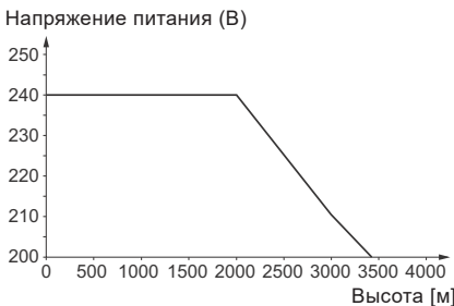
Рис. 15 Напряжение питания для однофазного электродвигателя в зависимости от высоты над уровнем моря
