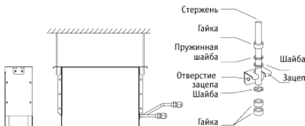
Способ 1. Подпотолочный монтаж
