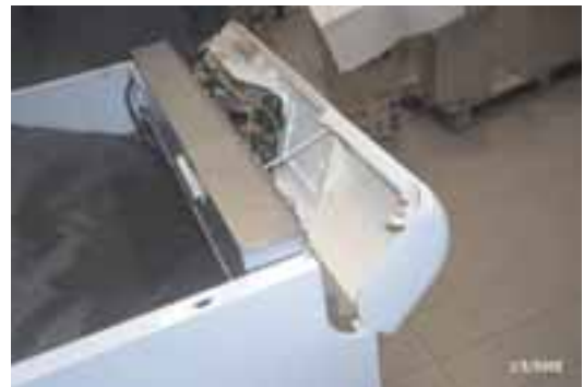
Рис. 6 - Поверните панель управления вперед.
