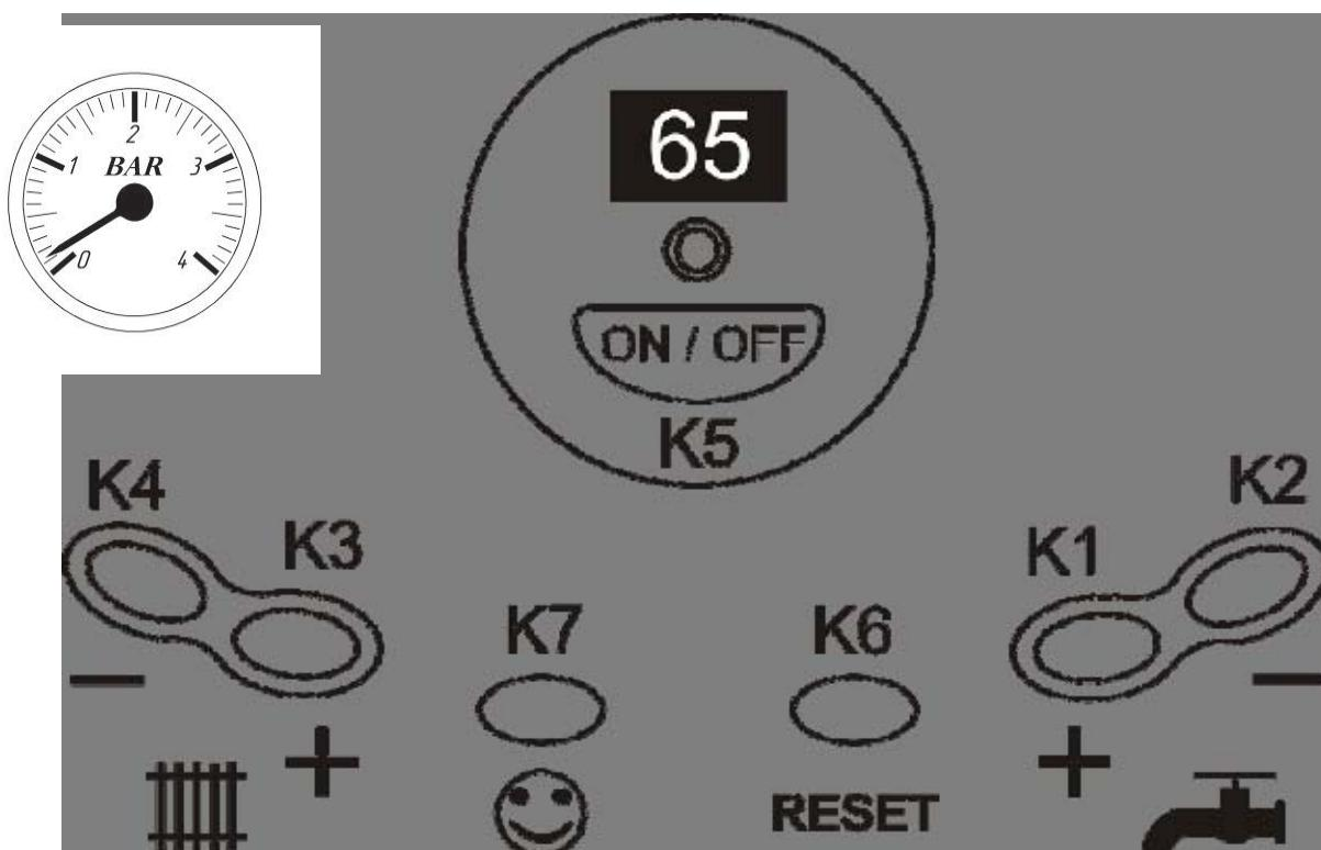
Рис. 9. Панель управления котлом
