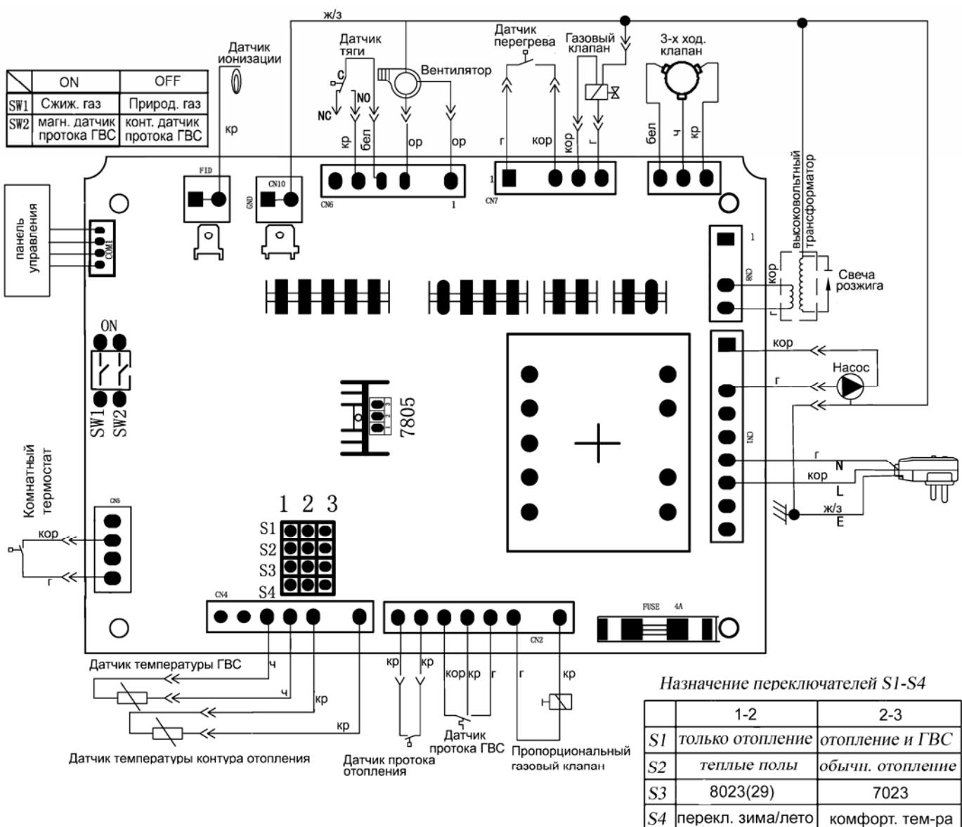
Рис. 4. Схема электрических соединений котла
