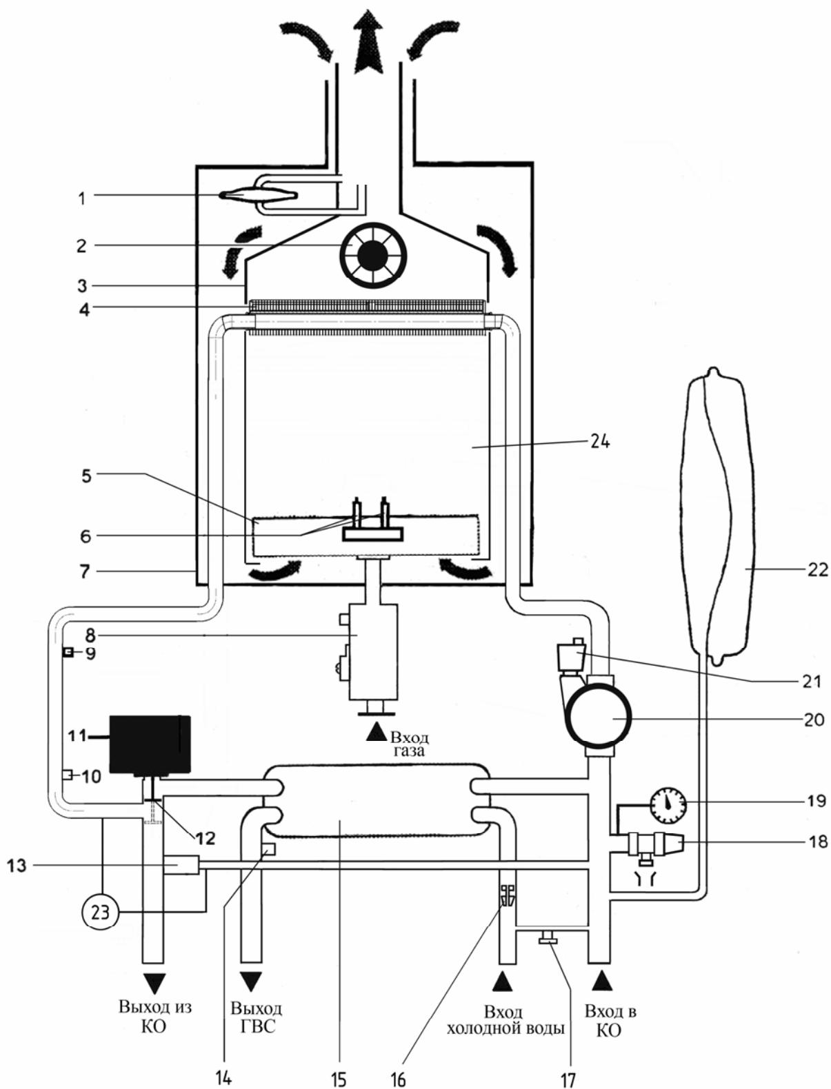
Рис. 3. Функциональная схема котла «NEVALUX-8023» и «NEVALUX-8029»
