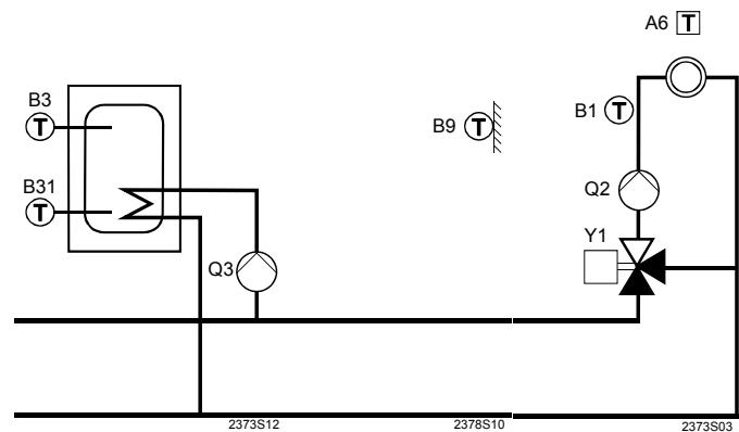
Тип оборудования №11 Регулирование смесительной отопительной зоны.
