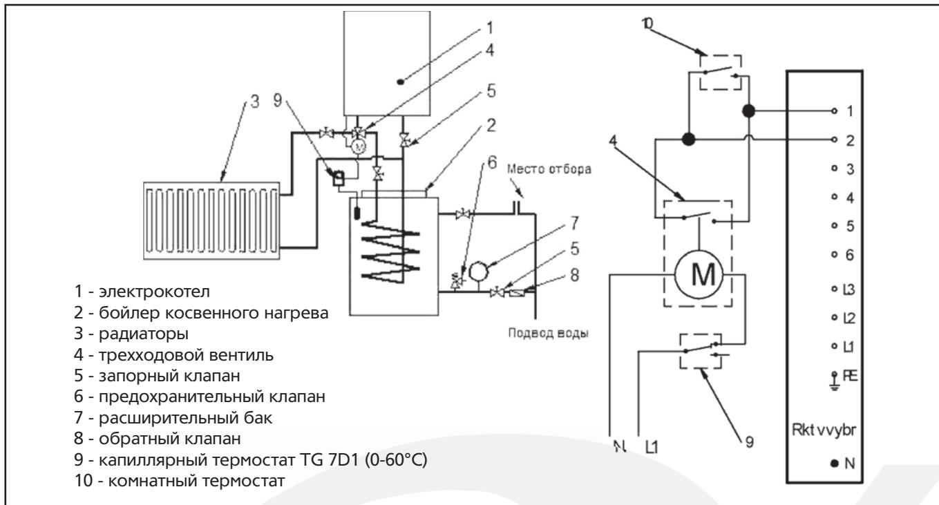
ника тепла, составной частью которого не является циркуляционный насос. Подключение должно быть произведено посредством термостата минимума второго источника тепла (который надо подключить на клеммы 5, 6 котла ZETA), с помощью которого потом управляет насос котла. Это подключение можно выгодно применить при совместной работе с другим источником тепла, например с тепловым насосом, или камином с металлической топкой и т.п., когда уже не надо подключать в систему ни дальний насос, ни управление.
