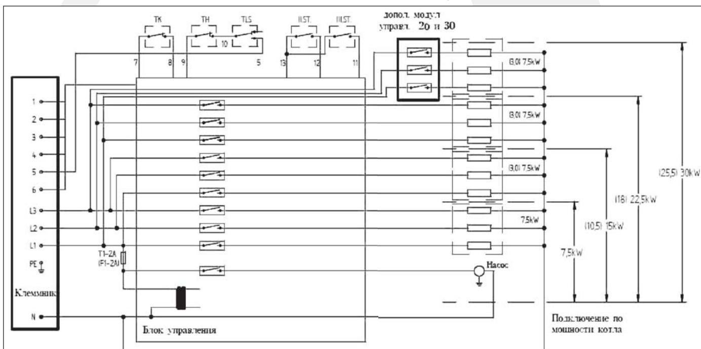
Электрическое подключение котла мощностью 7,5кВт коднофазной розетке (220 Вольт)
