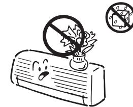
При попадании воды внутрь кондиционера возможно нарушение изоляции проводов, что чревато коротким замыканием или поражением электротоком .
