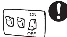
В процессе чистки при работающем кондиционере можно получить травму врачающимся вентилятором.
