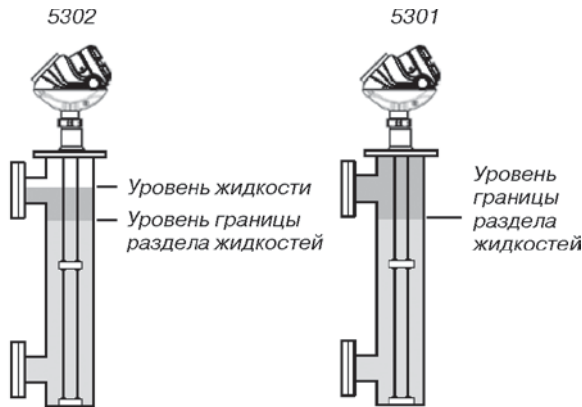
Рис. 8. Измерение уровня границы раздела при помощи Rosemount 5302 и Rosemount 5301 (с зондом, полностью погруженным в жидкость).
