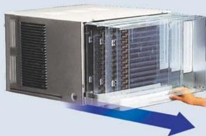
Оконный кондиционер Samsung легко устанавливать, потому что шасси основного блока выдвигается из кожуха по специальным салазкам. Сначала закрепите легкий кожух на стене или в оконном проеме, а затем просто вдвиньте по салазкам внутрь кожуха основной блок. Вот и все, что требуется для установки оконного кондиционера Samsung.
