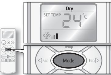
Каждый раз вы нажмете кнопку **Mode**, режим будет изменен в следующие типы: Auto (Авто), Cool (Охлаждение), Dry (Влагопоглощение), Fan (Вентилятор) и Heat (Обогрев).
