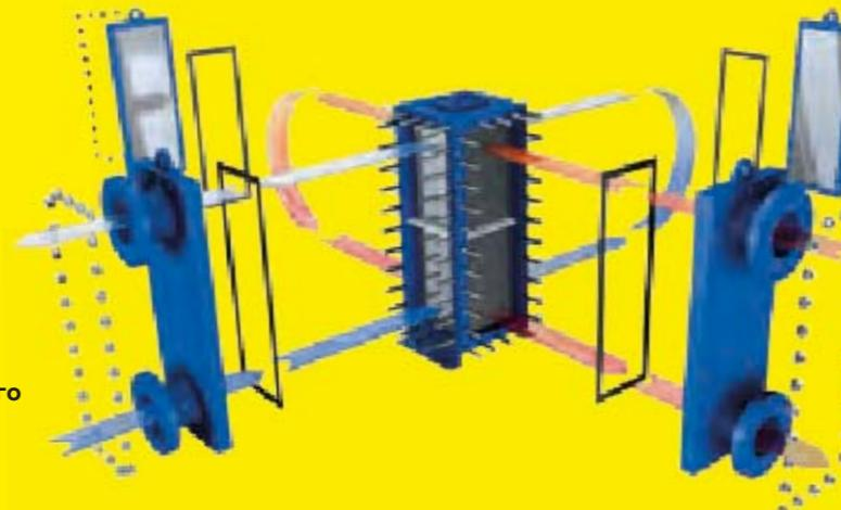
2 Конструкция одноходового теплообменника
