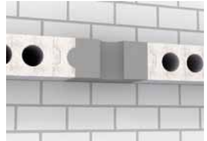
Перекрытие из пористого бетона (возможно с пустотами)
