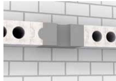
Перекрытие из пористого бетона (возможно с пустотами)
