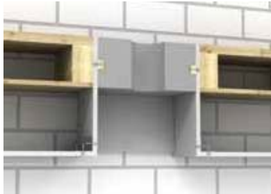
Перекрытие с деревянными балками с подшивным потолком
