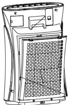
Снимите решетку воздухозаборника и фильтр предварительной очистки
