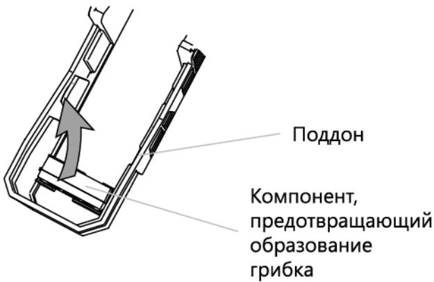
Техническое обслуживание фильтра, предотвращающего образование грибка
