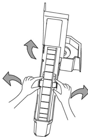
Выдвиньте поддержку поддона для воды двумя большими пальцами и вытолкните колесо из поддона.
