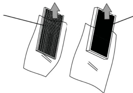
**Гофрированный фильтр тонкой очистки (HEPA):**
