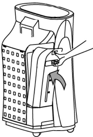
После заполнения резервуара для воды, установить резервуар в поддон, сначала нижнюю часть, затем верхнюю, защелкните верхний фиксатор. Вставьте вилку шнура питания
