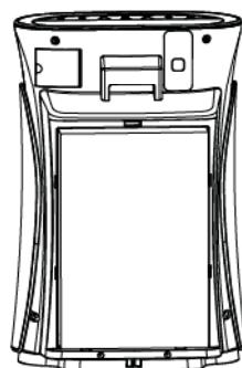
Снимите фильтр тонкой очистки (HEPA) и дезодорирующий фильтр
